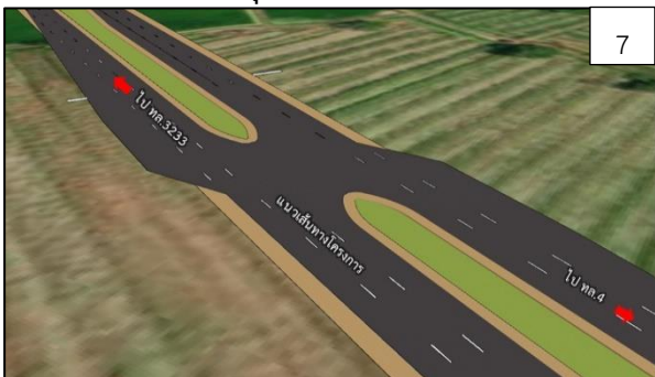
จุดกลับรถ (ระดับพื้น) บริเวณ หมู่ที่ 4 ตำบลวัดแค
