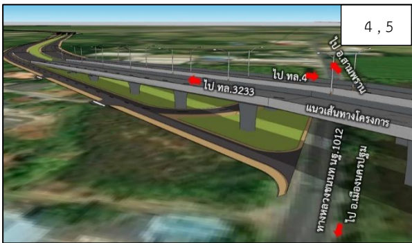
ทางยกระดับข้ามถนนทางหลวงชนบท สาย นพ.1012 และจุดกลับรถใต้สะพาน
